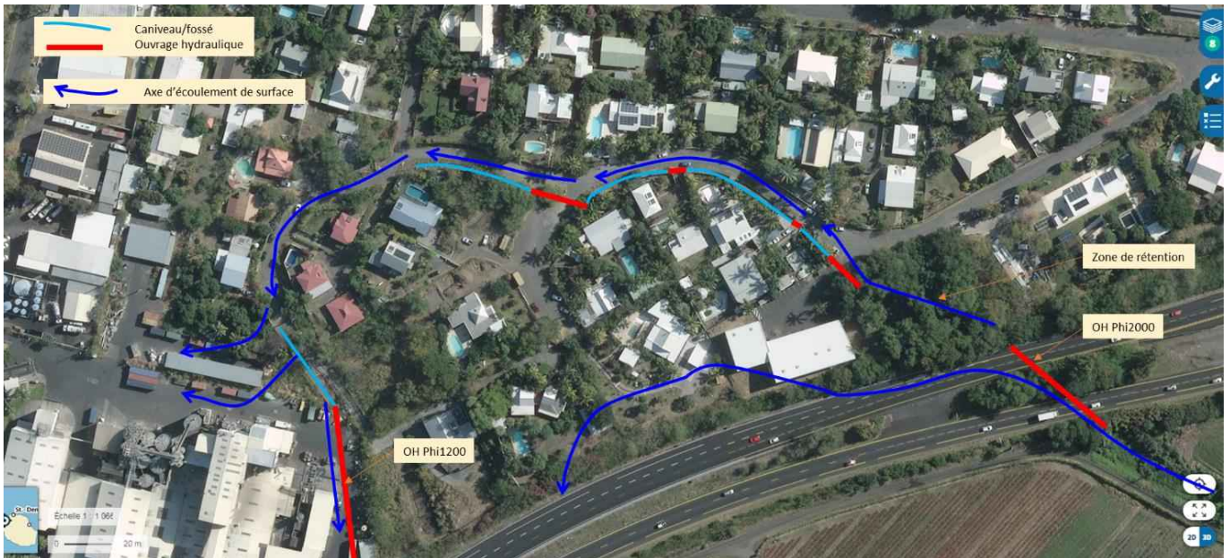
Figure 25 : schématisation des écoulements sur le secteur amont
