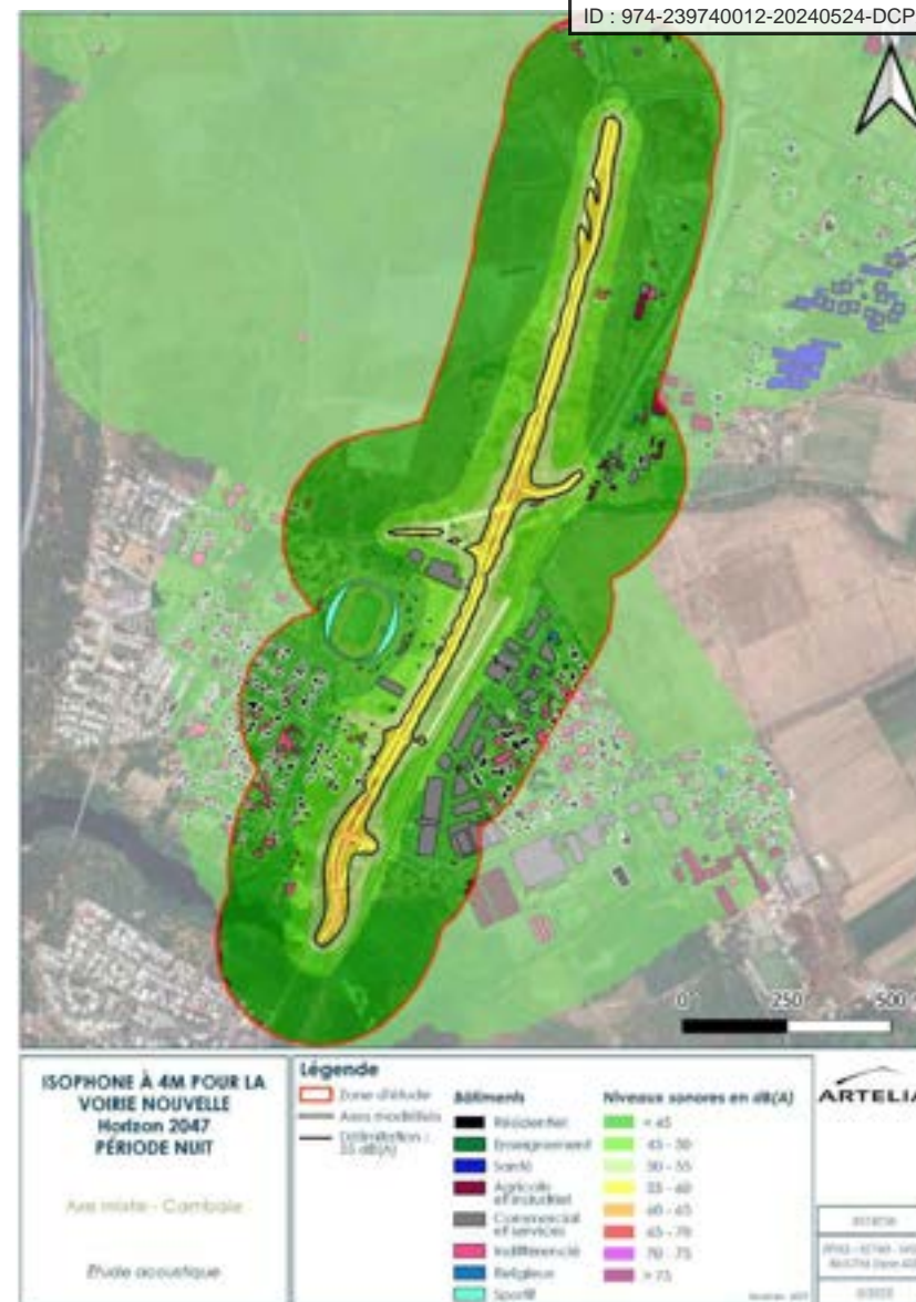
Figure 19 - Carte des isophones à 4m du sol - nouvelle voirie scénario projet 2047 - Période nocturne
