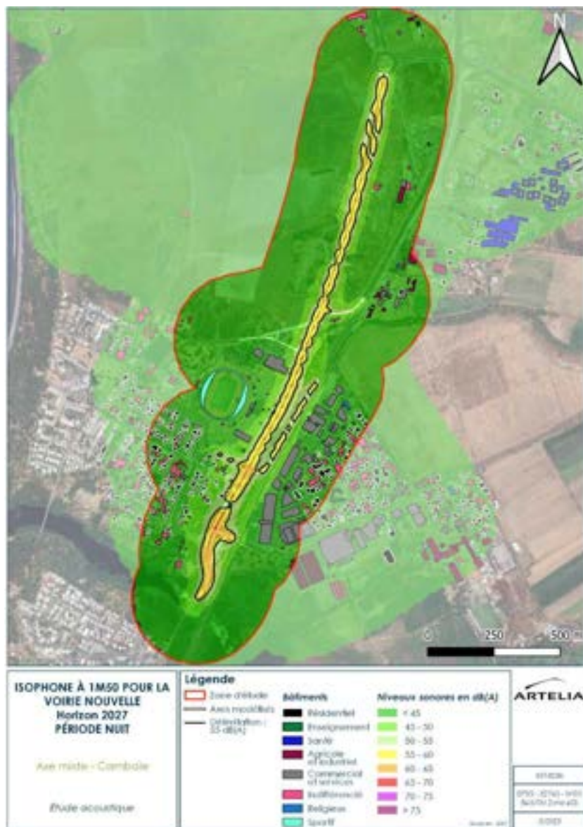
Figure 14 - Carte des isophones à 1m50 du sol - nouvelle voirie scénario projet 2027 - Période nocturne
