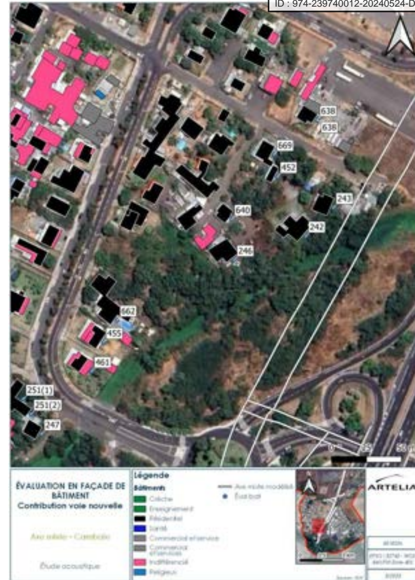
Figure 22 - Évaluation en façade des bâtiments - Contribution sonore de la voie nouvelle seule
