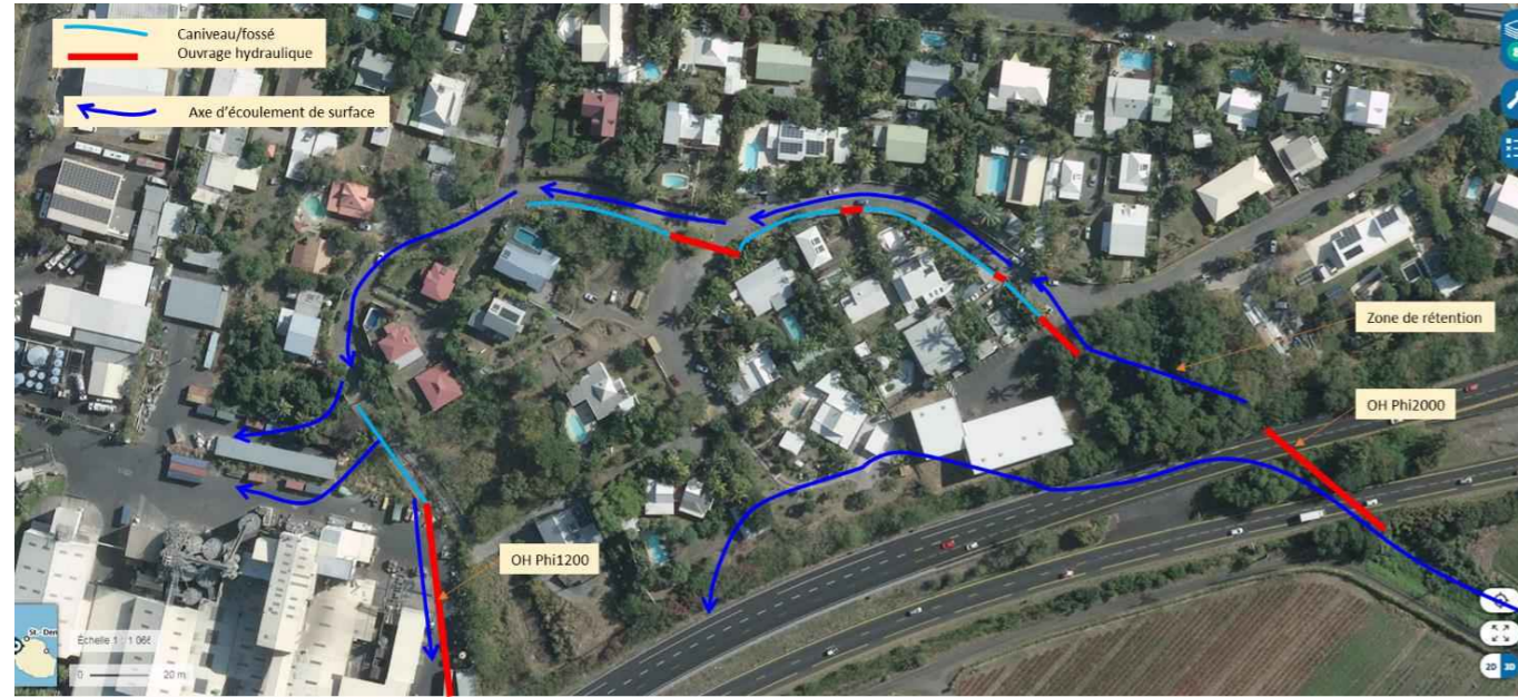
Figure 14 : schématisation des écoulements sur le secteur amont
