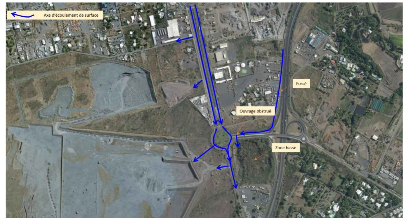
Figure 25 : schématisation des écoulements sur le secteur aval
