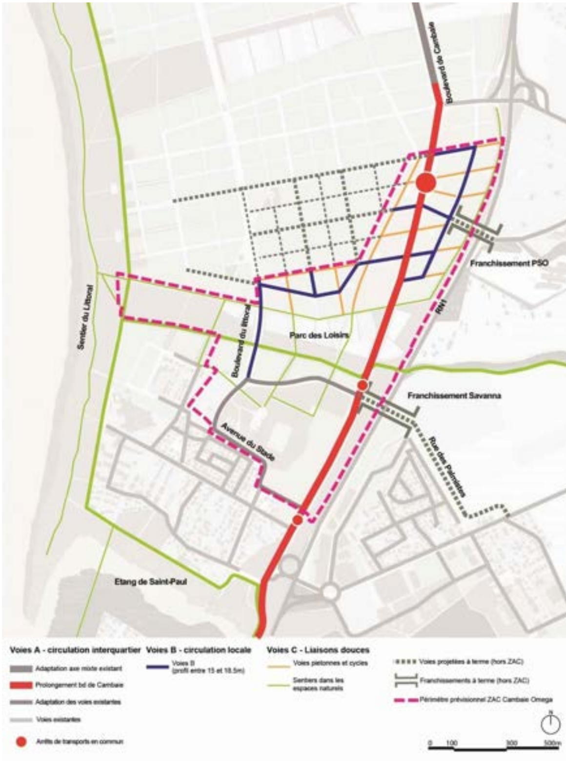
Figure 128 Schéma de principe de l'armature viaire de la ZAC Cambaie-Omega
