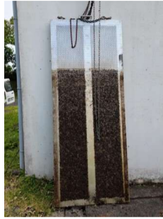
Photo 4 –Grille de filtration de l'étage 1
